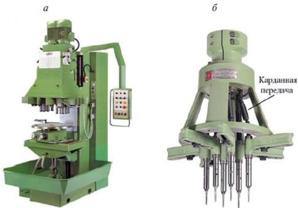
Рис. 5.3. Станок (а) с многошпindleльной сверлильной головкой (б)
